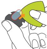
浮いたレンズガラスにピックの先端をさし入れ、アクリル板からレンズガラスを剥がします。
