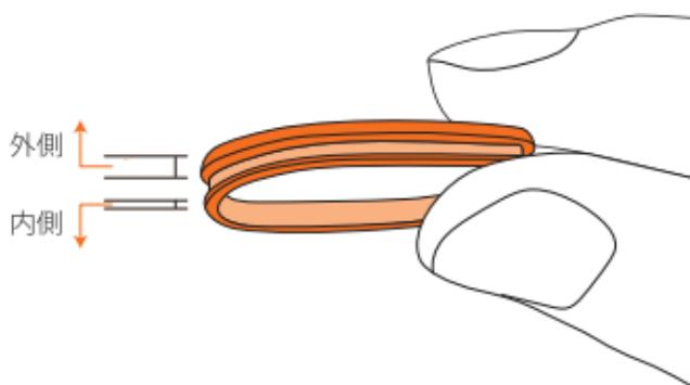
② 背面にレンズリングの溝をはめていきます。隙間がないようにしっかりと指で押さえてください。
